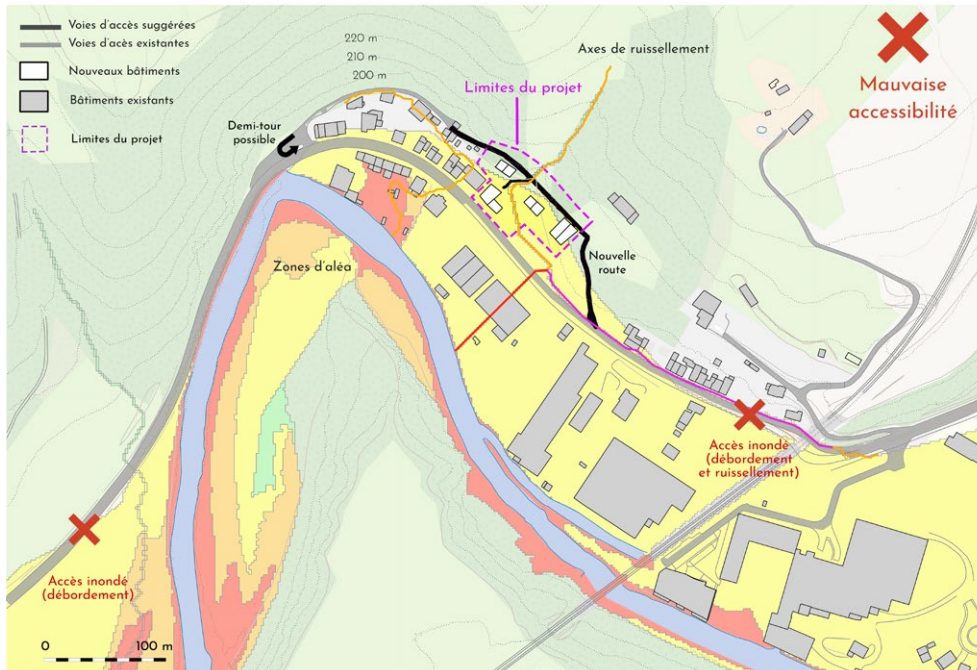
Figure 17. Extrait du plan de localisation avec figuration des accès. Exemple de mauvaise accessibilité. Les croix rouges indiquent un accès bloqué (inondé).
